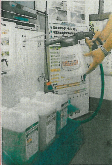
旅館などの大規模浴場向けに開発した専用の洗剤と発泡噴射装置
